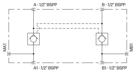
Valvola di ritegno pilotato doppio con attacchi filettati 1/2" BSPP adatta per applicazioni gravose.
