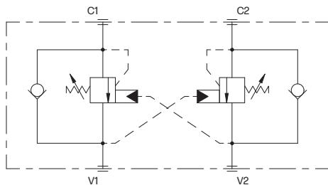
Valvola Overcenter in Acciaio INOX in linea con attacchi filettati da 3/8" BSPP
