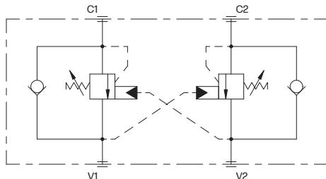
Valvola Overcenter in Acciaio INOX in linea con attacchi filettati da 1/4" BSPP o 3/8" BSPP.
