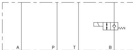
Elemento modulare CETOP 3 in acciaio, dotato di cartuccia/e elettriche con funzione di ritegno sui condotti A e B.
