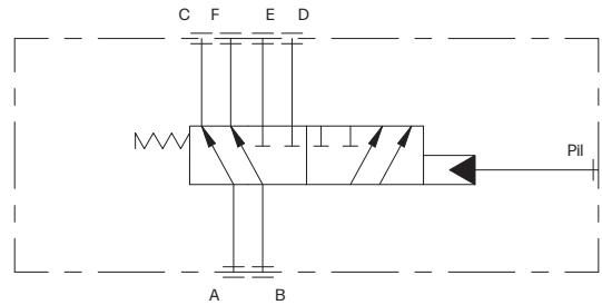
Valvola direzionale in linea 6 vie a 2 posizioni. Attacchi filettati da 1" 1/4 BSPP. Corpo in acciaio con ingombri ridotti e di facile montaggio.
