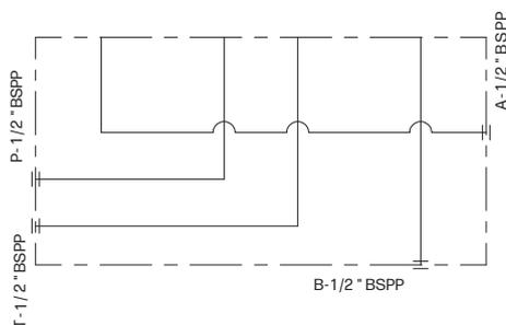
Base singola per montaggio elementi con interfaccia CETOP 3 adatta al montaggio su cilindri.
