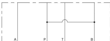
Elemento modulare di collegamento P in B CETOP 3.
